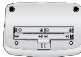
Установка элементов питания
